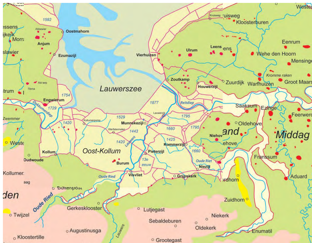
Figure 5.7.1: Overview of the diking of the Lauwerszee area, dark line gives maximum extent. After: http://landschapsgeschiedenis.nl/deelgebieden/6-Lauwersland.html
